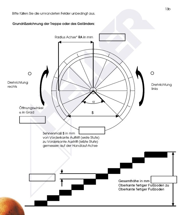
\* Radius Achse **RA** ist der Radius vom Treppenmittelpunkt bis zur Mitte des Handlaufs.
